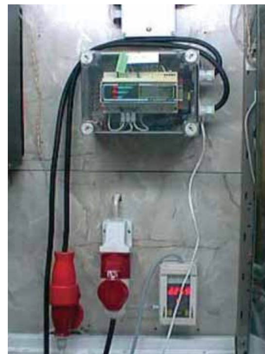
Энергопотребление каждой из испытываемых машин непрерывно замеряется напрямую. Когда машины закончат работу, будет подсчитано интегральное значение энергопотребления.
